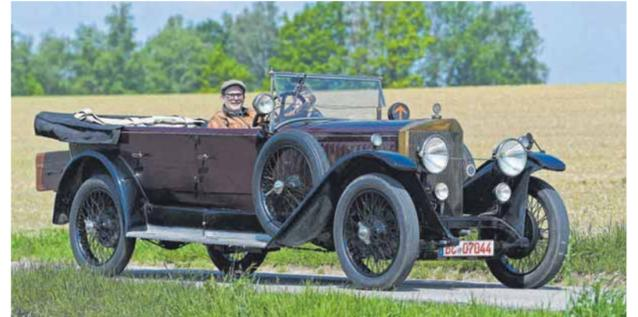
Kein kleines Auto: Der Steiger misst fünfeinhalb Meter und wiegt 1,7 Tonnen. Der Motor ist extrem langhubig konstruiert (Bohrung x Hub: 75 x 160 Millimeter).
