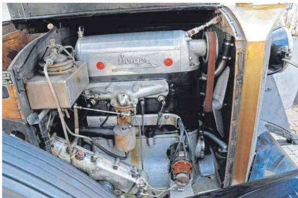
Der 2,7-Liter-Vierzylinder-Motor, extrem langhubig konstruiert (langhubiger als jeder andere Motor in der Automobilgeschichte), leistet 55 PS.
